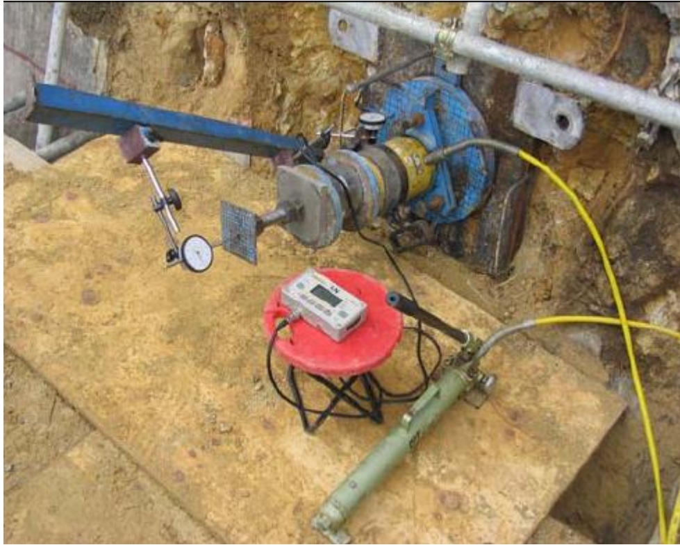
شکل 1-2- آزمایش بارگذاری نیل
