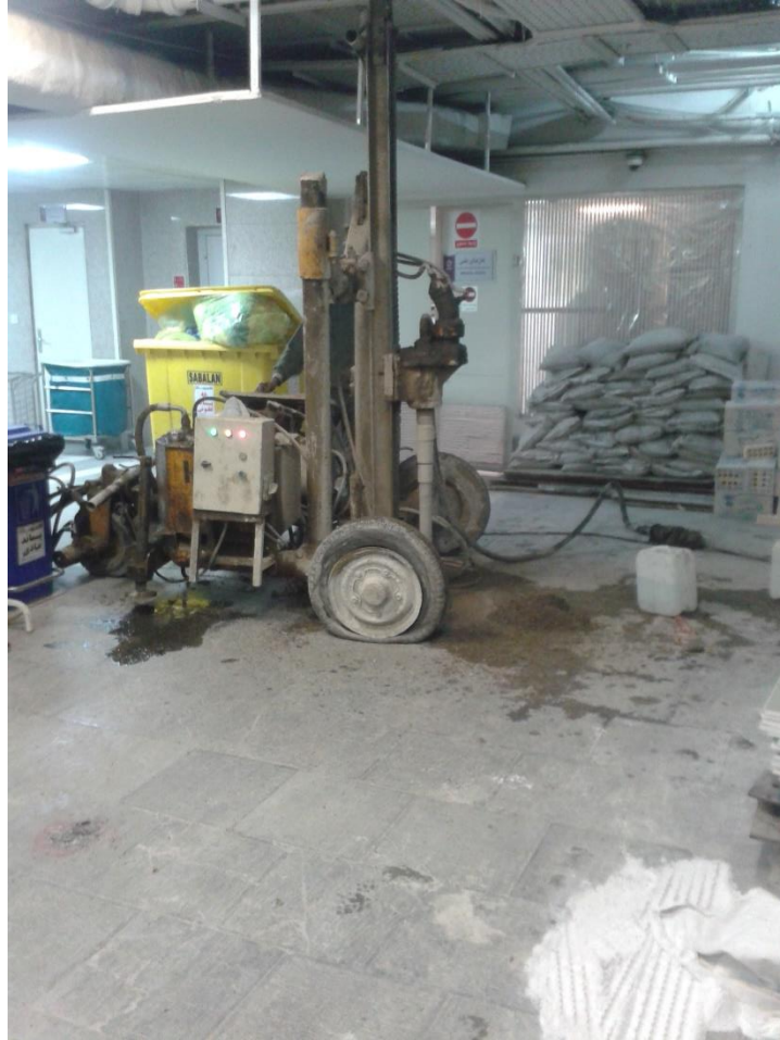
تصویر 2-4: مته دورانی هیدرولیکی کوچک نصب شده روی قاب
